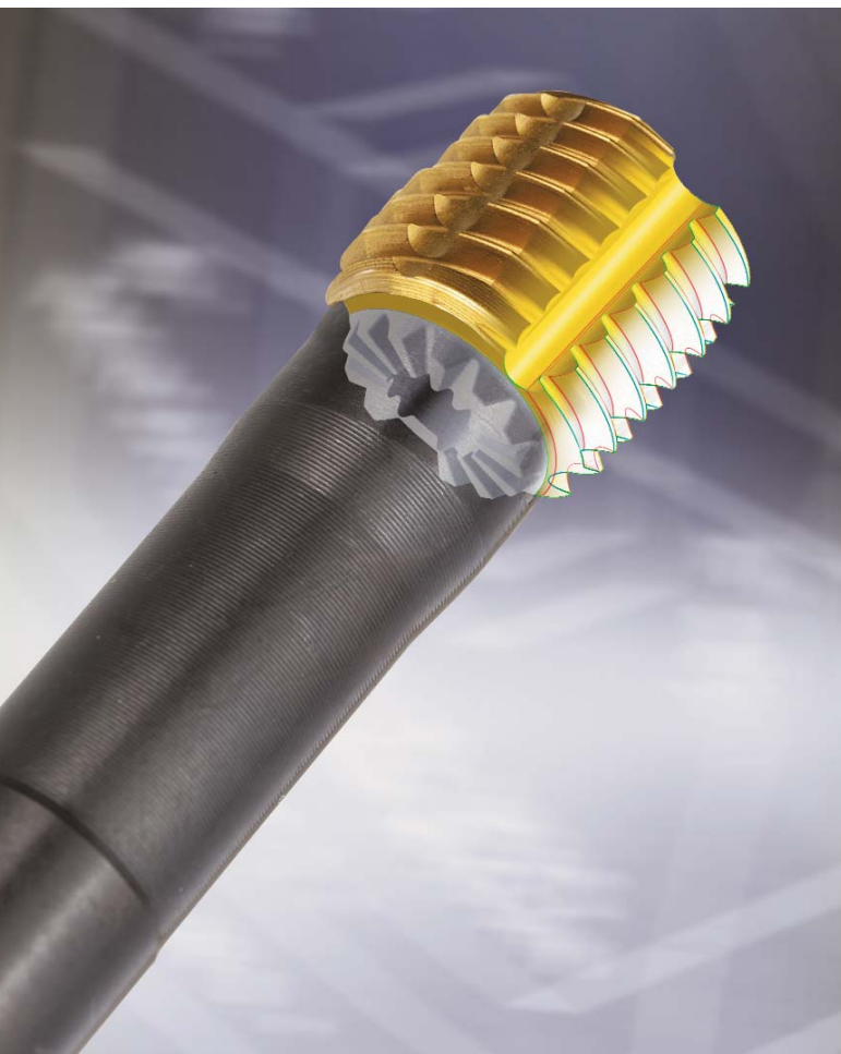
Contextura de las fibras durante el laminado de roscas Traçado das fibras na modelagem de rosca
